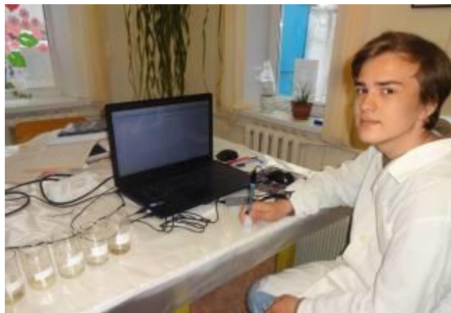
Рис. 15. Определение удельной электропроводности и актуальной кислотности датчиками.
