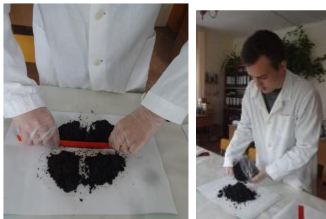
Рис. 7-8. Отбор усреднённой навески методом квартования.
