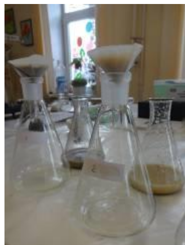
Рис. 13-14. Определение актуальной кислотности: размешивание с помощью магнитной мешалки и отфильтрование водной вытяжки
