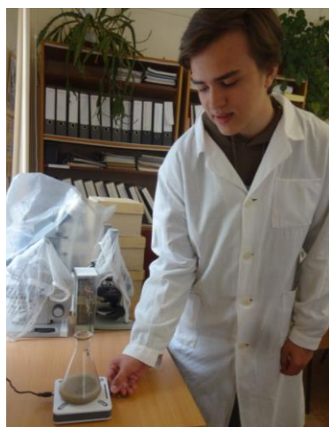
Рис. 13-14. Определение актуальной кислотности: размешивание с помощью магнитной мешалки и отфильтрование водной вытяжки
